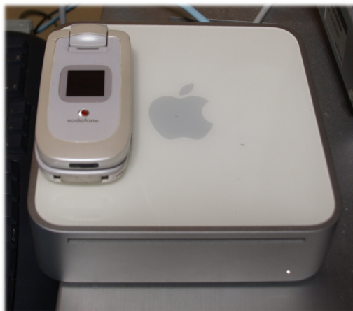
Figure 3.3: サーバ機にする MAC mini. 携帯電話は大きさを比較するために置いている. 寸法は 16.5 \times 16.5 \times 5 [cm] と公表されている.
